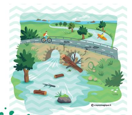
Des branchages peuvent se coincer au niveau de la pile d'un pont... mettant en péril l'ouvrage avec risque d'effondrement.
